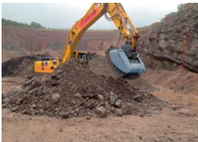
Рис. 11. Установить ковш вертикально и включить дробилку.
