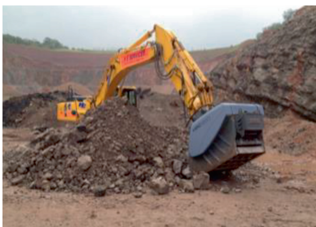
Рис. 10. Загрузка дробильного ковша.
